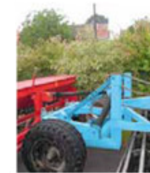
Transport chassis with seeder hoist / das Fahrgestell mit oder ohne Hydropack / chariot de transport
