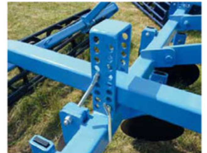
working depth adjustment on the frame / Einstellung der Arbeitstiefe mittels Lochleisten / réglage de la profondeur de travail
