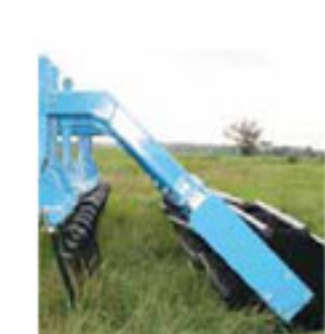
Tines front of the roller / Striegelbalken vor der Walze / Herse à peigne avant le rouleau
