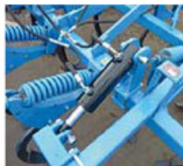
Hydraulic adjustment of working depth / hydraulische Einstellung der Arbeitstiefe / Reglage hydraulique de la profondeur de travail
