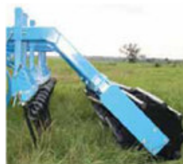
Tines front of the roller / Striegelbalken vor der Walze / Herse à peigne avant le rouleau
