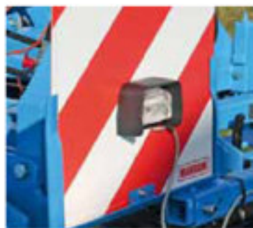
Transport lights / Beleuchtungsanlage mit Warntafel / Eclairage de route
