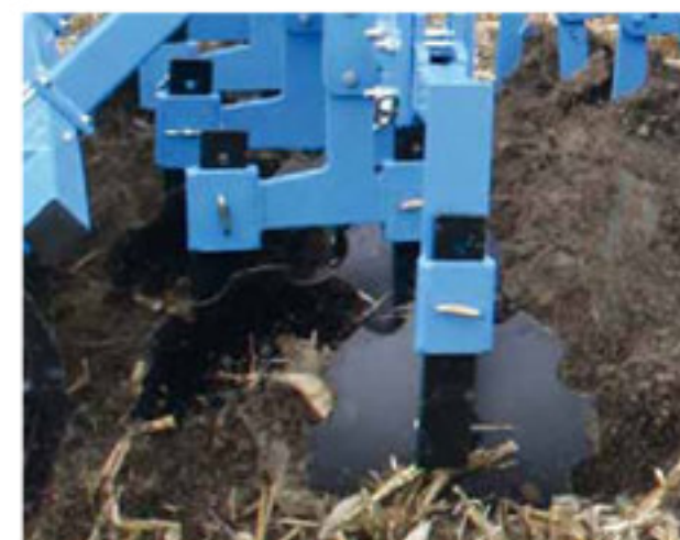
notched discs 465 mm / die gezackten Scheiben 465 mm / disques crenelees 465 mm
