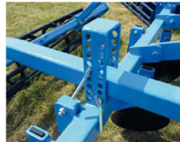
working depth adjustment on the frame / die Einstellung der Arbeitstiefe mittels Lochleisten / réglage de la profondeur de travail
