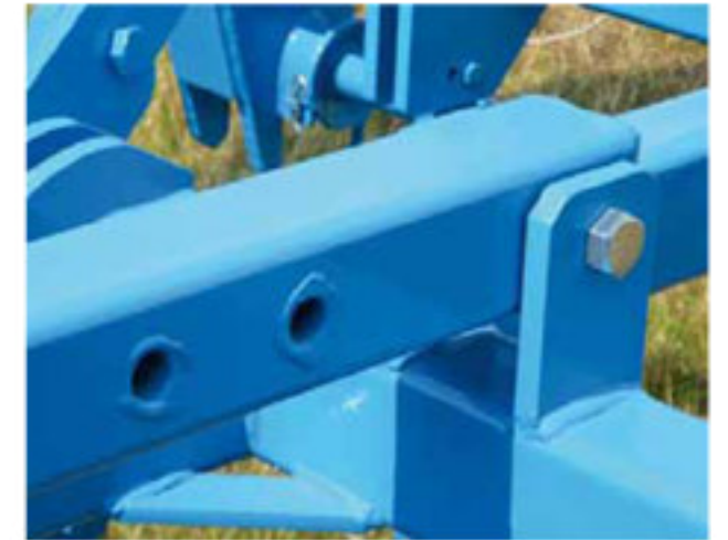
adjustment of the roller offset / die Einstellung des Walzenabstandes hinter der Maschine / réglage de décalage de rouleau
