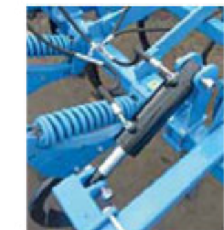
Hydraulic adjustment of working depth / die hydraulische einstellung der Arbeitstiefe / Reglage hydraulique de la profondeur de travail
