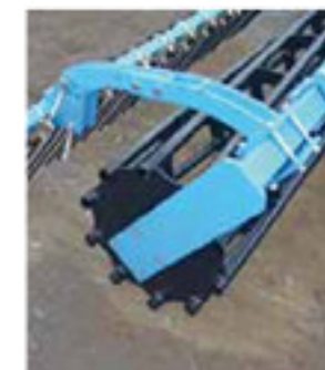
Tines after roller / Striegelbalken hinter der Walze / Herse à peigne derrière le rouleau
